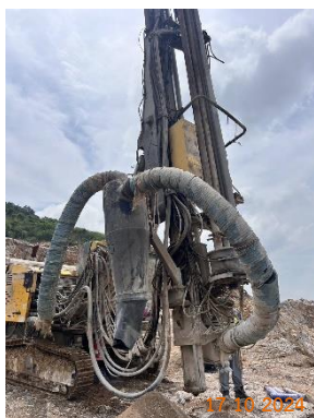
รูปที่ 2-11 เครื่องเจาะรูระเบิด ที่มีระบบ Cyclone และถูกรอง
